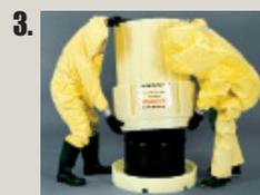
Técnica del Roller: Ponga en su lado el tambor y el overpack con tubos de metal (ej: pipa de agua) debajo. Roda el tambor casi adentro. Poco a poco ponga el overpack en posición vertical.
